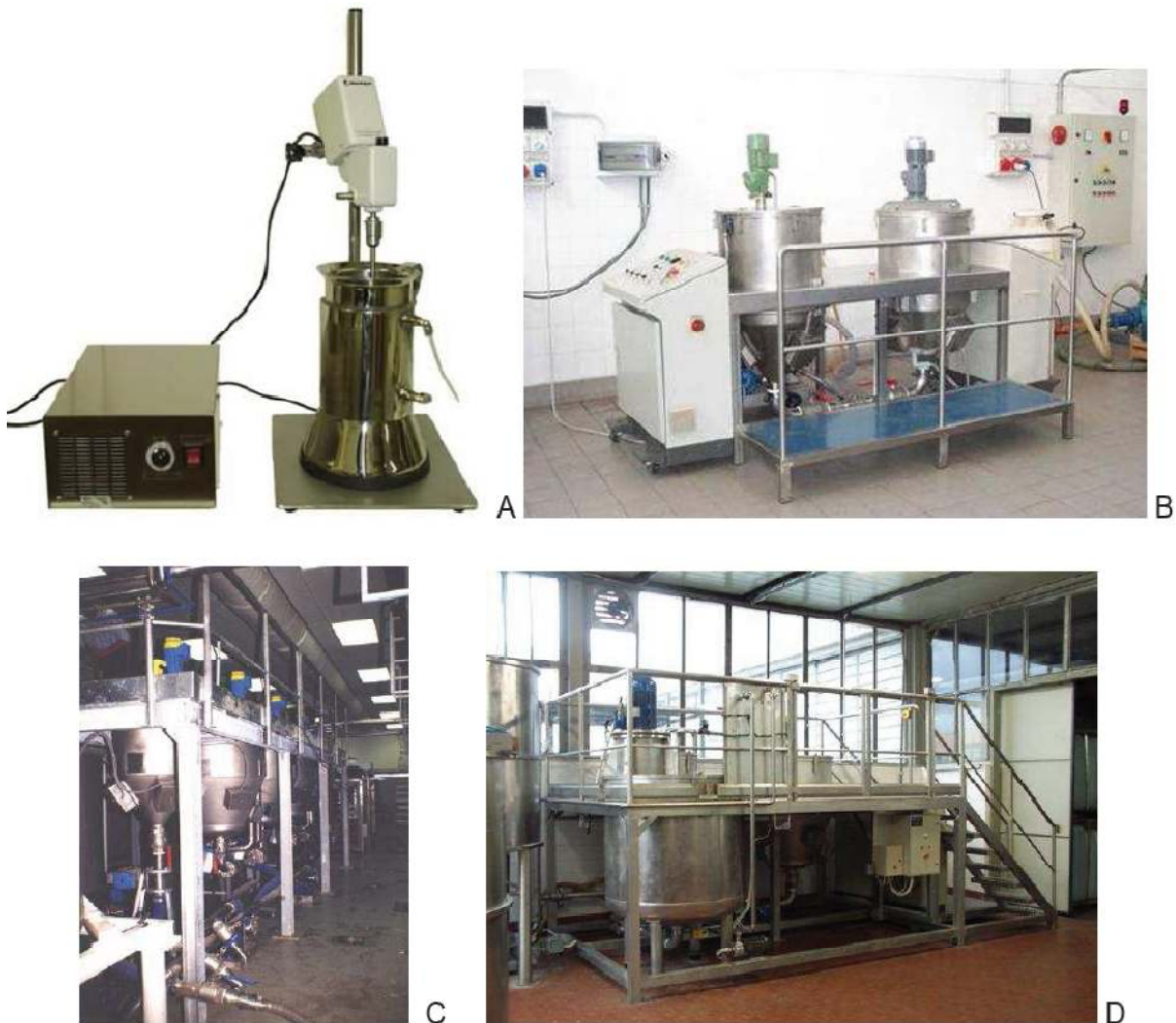
Figure 1.3.3. Gamme de nouveaux appareillages développée par la société REUS (France) ; réacteur d'extraction assistée par ultrasons de 3 L, (B) équipement à l'échelle pilote : cuve de 50 L et (C et D) équipement à l'échelle industrielle : cuves de 500 et 1000 L [20,21].
