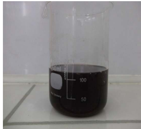
Figure IV.2 : Solution des ferrates après 120 minutes d'électrolyse.
