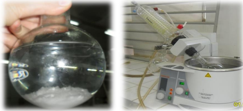
Figure 3.30 - Elimination d'eau par \text{Na}_2\text{SO}_4 Figure 3.31 - Evaporateur rotatif (photographies originales)
