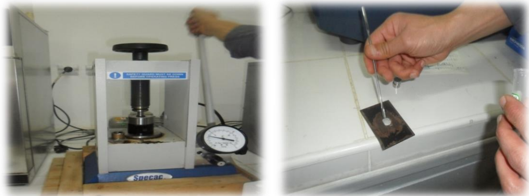
Figure 3.36 -Pastilleuse Figure 3.37 -Etalement d'huile essentielle sur la pastille KBr
