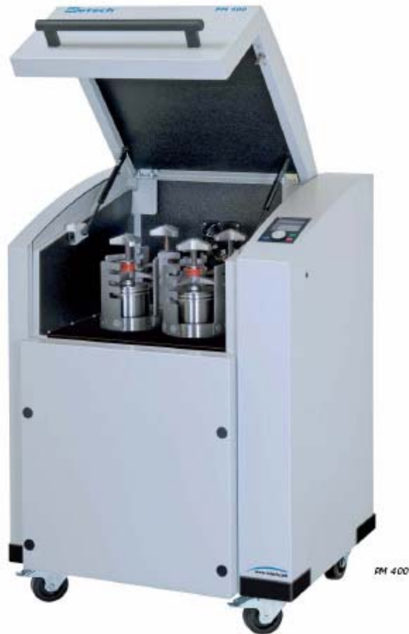
Figure 4.1 : Broyeur planétaire type PM 400 [71].
