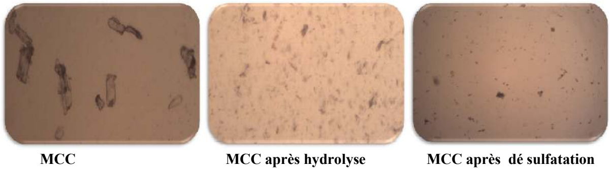
Figure (4.11) : Images microscopiques montrant l'effet d'hydrolyse acide sur la cellulose microcristalline.
