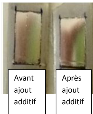
Figure 4.17 photo montrant l'aspect de la surface avant et après ajout d'additif t=18 \text{ min} .
