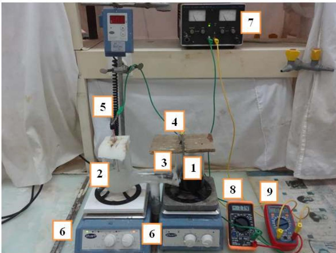
**Figure 2.1 :** Montage expérimentale utilisé pour la synthèse électrochimique des ferrates.
