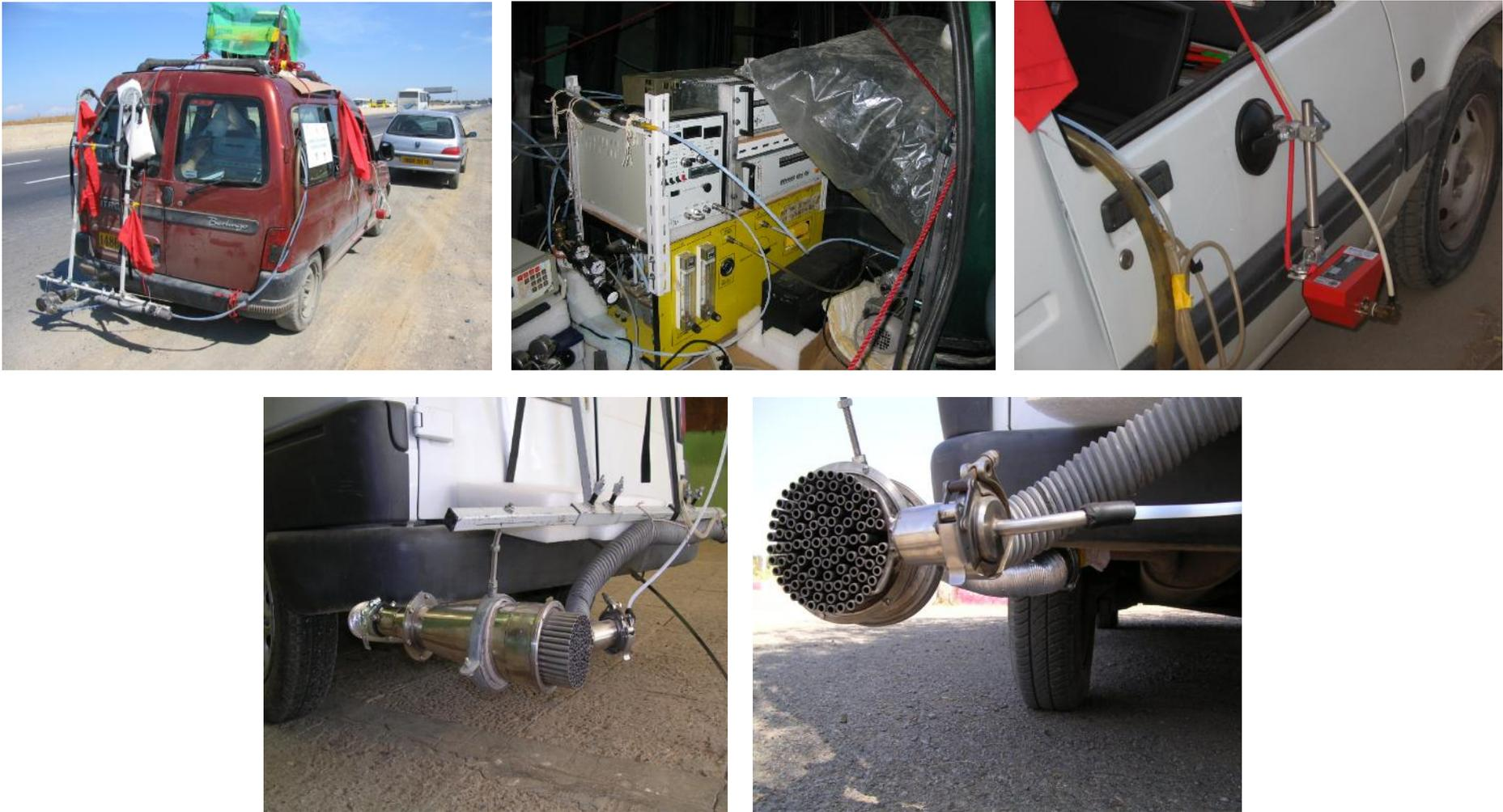
**Figure 5.2 : Photos du montage expérimental de mesure embarqué en circulation réelle**
