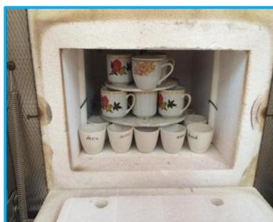
**Figure 3:** Les échantillons d'aliment dans un four à moufle.
