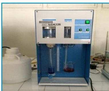
**Figure 5** : L'appareil distillatoire.
