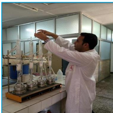
**Figure 6** : L'extraction des matières grasses dans l'appareil de Soxhlet.
