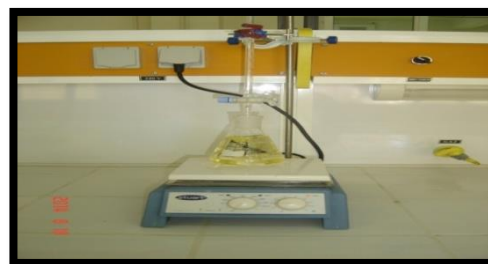
Figure 2.3.9 : Les étapes de la méthode de minéralisation (Méthode Kjeldahl).
