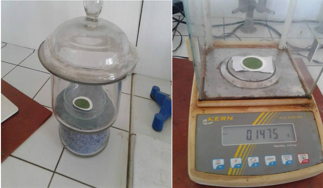
Figure II.6 : Photo numérique montrant le procédé de mesure des MES au laboratoire
