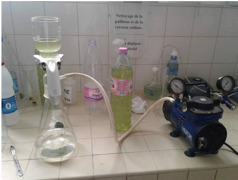
Figure II.5 : Photo numérique montrant le montage de la filtration sous vide
