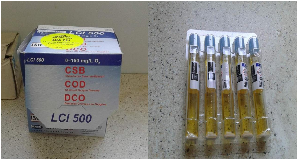
Figure II.2 : Photo numérique montrant les Réactifs utilisés pour la mesure de la DCO
