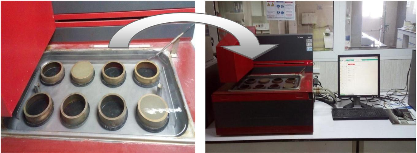
**Figure 12:** Appareil de Vicat automatique.
