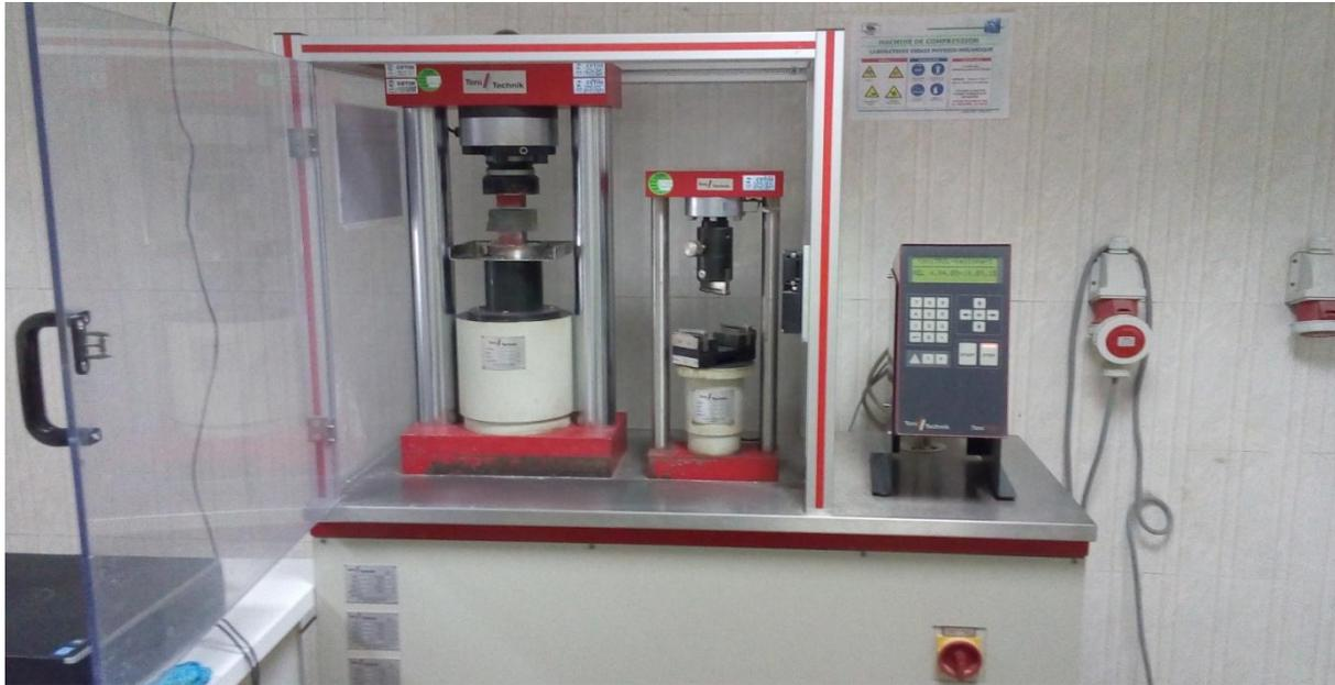
**Figure 7 :** presse pour les essais de flexion et de compression sur éprouvettes 4×4×16 cm
