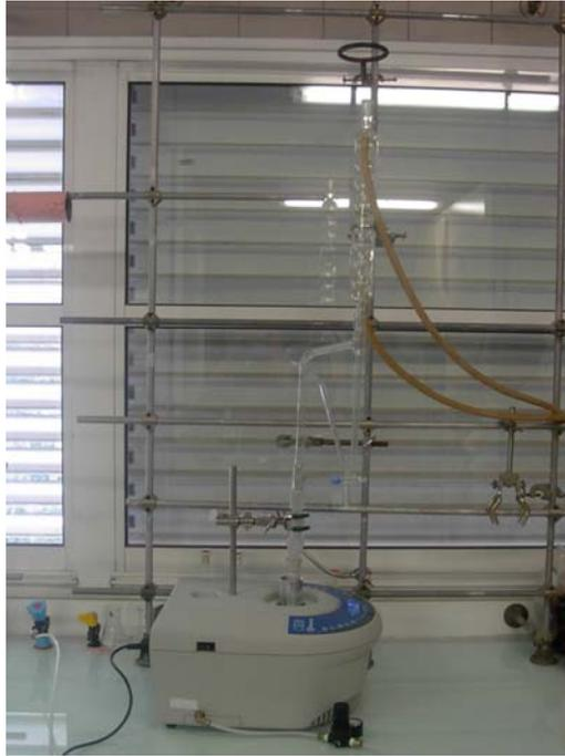
Figure 3.21 : Système d'hydrodistillation assistée aux micro-ondes
