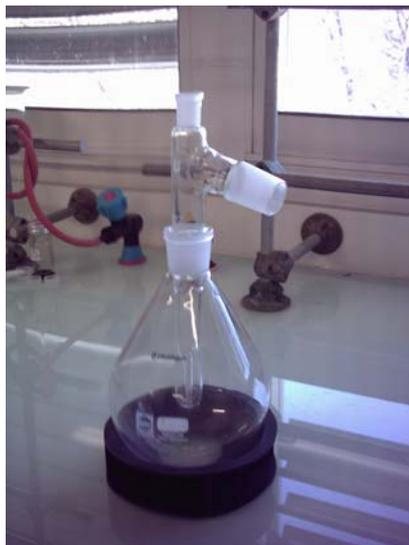
Figure 3.23 : Montage utilisé dans l'hydrodistillation
