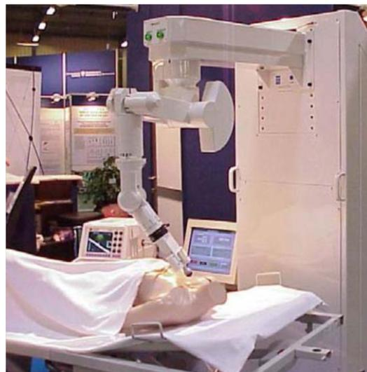
Figure 1.10: Le robot anthropomorphe le diagnostic par échographie.
