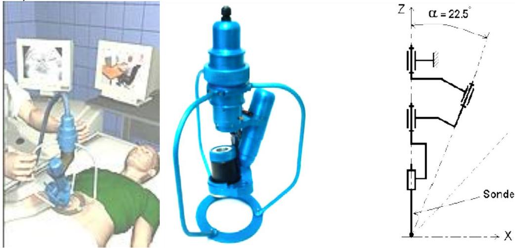
Figure 2. 20: Mécanisme sphérique pour l'orientation de la sonde "télé-échographie"
