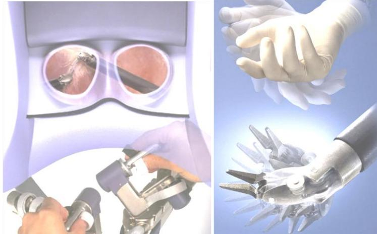
Figure 2.5: (a) Un système télé opéré. (b) Les bras robotisés de la structure esclave.
