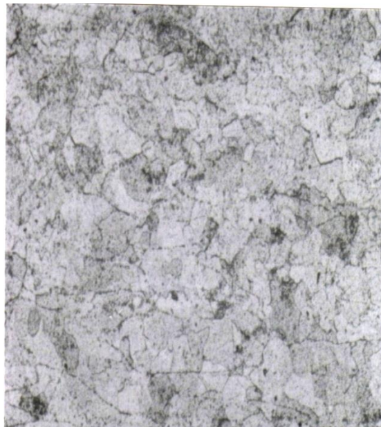
Figure 4.16 : Structure de 430 (Z8C17) à 30 % de déformation
