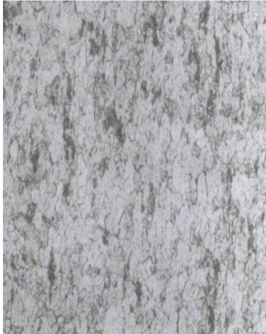
Figure 4.17 : Structure de 430 (Z8C17) 45% de déformation Recuit à 800°C(X200), Micrographie Optique.
