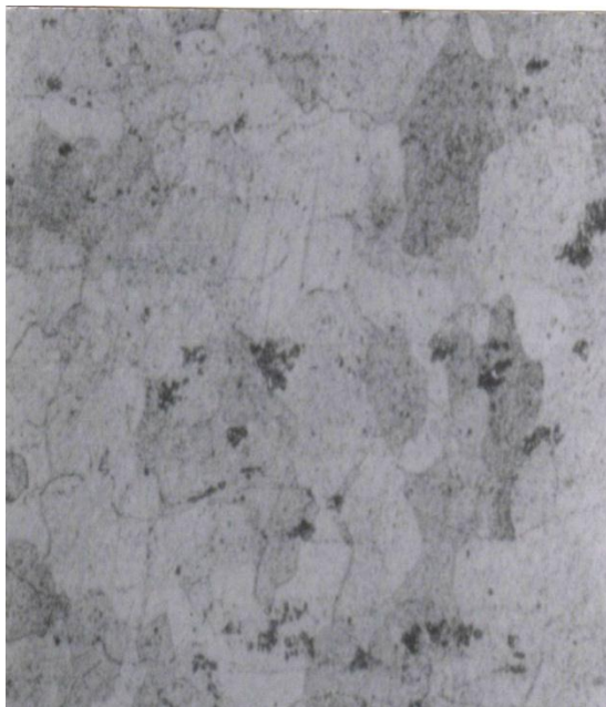
Figure 4.18 : Structure de 430 (Z8C17) 60%% de déformation Recuit à 800°C(X200), Micrographie Optique.
