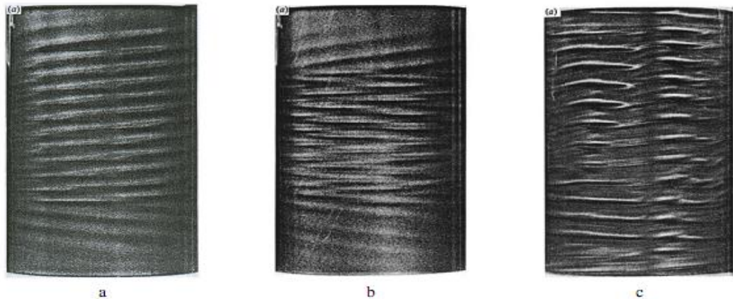
Fig. 1-4 – Visualisation par technique Kalliroscope de quelques-uns des motifs observés par Andereck et al, dans le cas où les deux parois cylindriques sont mobiles: a) Laminar Spiral flow (SPI), pour Re_o = -300 , Re_i = 240 ; b) Interpenetrating Spirals (IPS) pour Re_o = -1000 , Re_i = 435 ; c) Wavy Interpenetrating Spirals (WIS), pour Re_o = -300 , Re_i = 350 ([34]).
