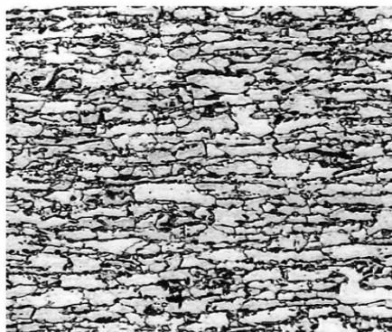
(a) acier de construction à grain fin obtenu par TTM (tôle quarto pour tube)
