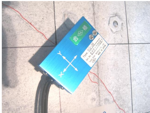
Figure 3.15 : Principe de montage des fissuromètres bidirectionnels.
