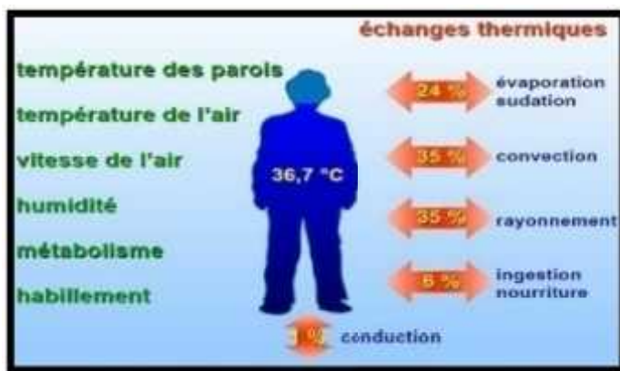
Figure 39 : Les paramètres de confort thermique Sources : bourgogne bâtiment durable « bâtiment intelligent et qualité d'usage » les cahiers de la construction durable en bourgogne n°4, décembre 2013.
