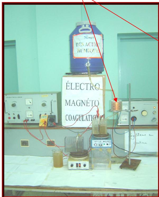
Figure 7.5 Photo du dispositif expérimental (TM-BIEC) pour trajet hélicoïdal.
