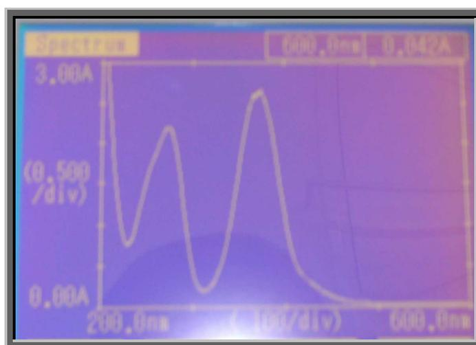
Figure 7.38 Balayage UV-vis de la solution d'AH traitée par EC avec électrodes en acier inoxydable. Deux pics sont présents à  $\lambda_{1\max} = 375 \text{ nm}$  et  $\lambda_{2\max} = 242 \text{ nm}$ .
