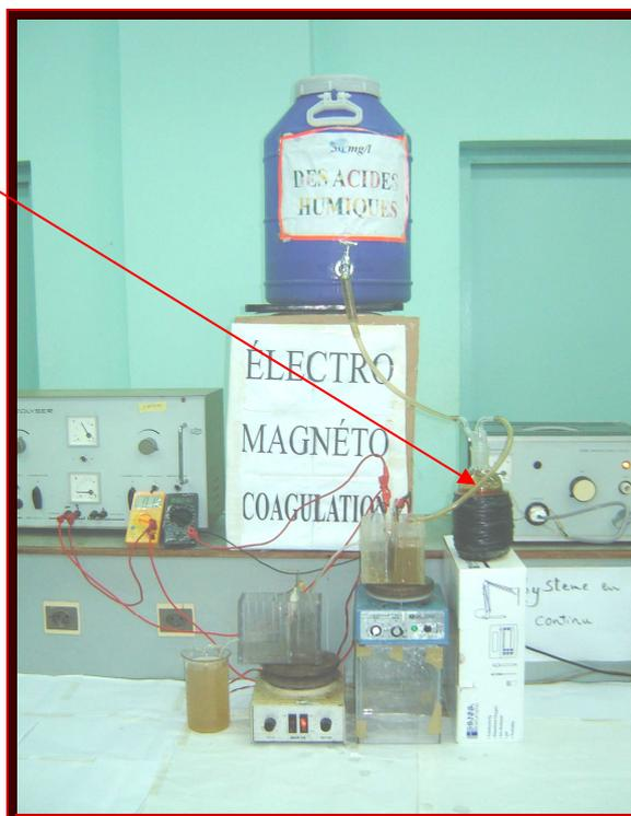
Figure 7.6 Photo du dispositif expérimental (TM-BIEC) pour trajet direct.
