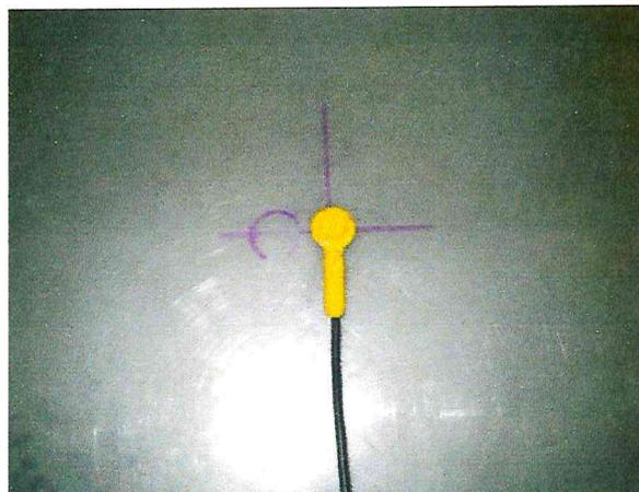
*Figure. IV.4.7. la diode QED type N est collée au centre du champ.*
