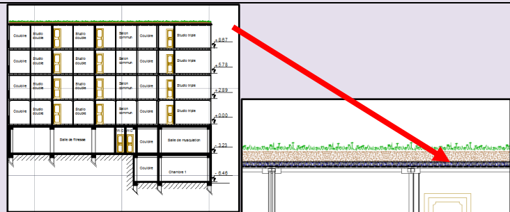
Figure 223 : coupe schématique montrant la toiture végétale
