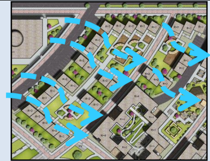
Figure 176 : percées face aux vents
