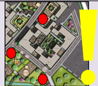
Figure 253 : positionnement puits canadien Source : auteur
