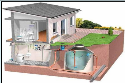
Figure 80 : Réservoir des eaux pluviales Source : http://www.renover-ecologique.com/recuperation-deau/
