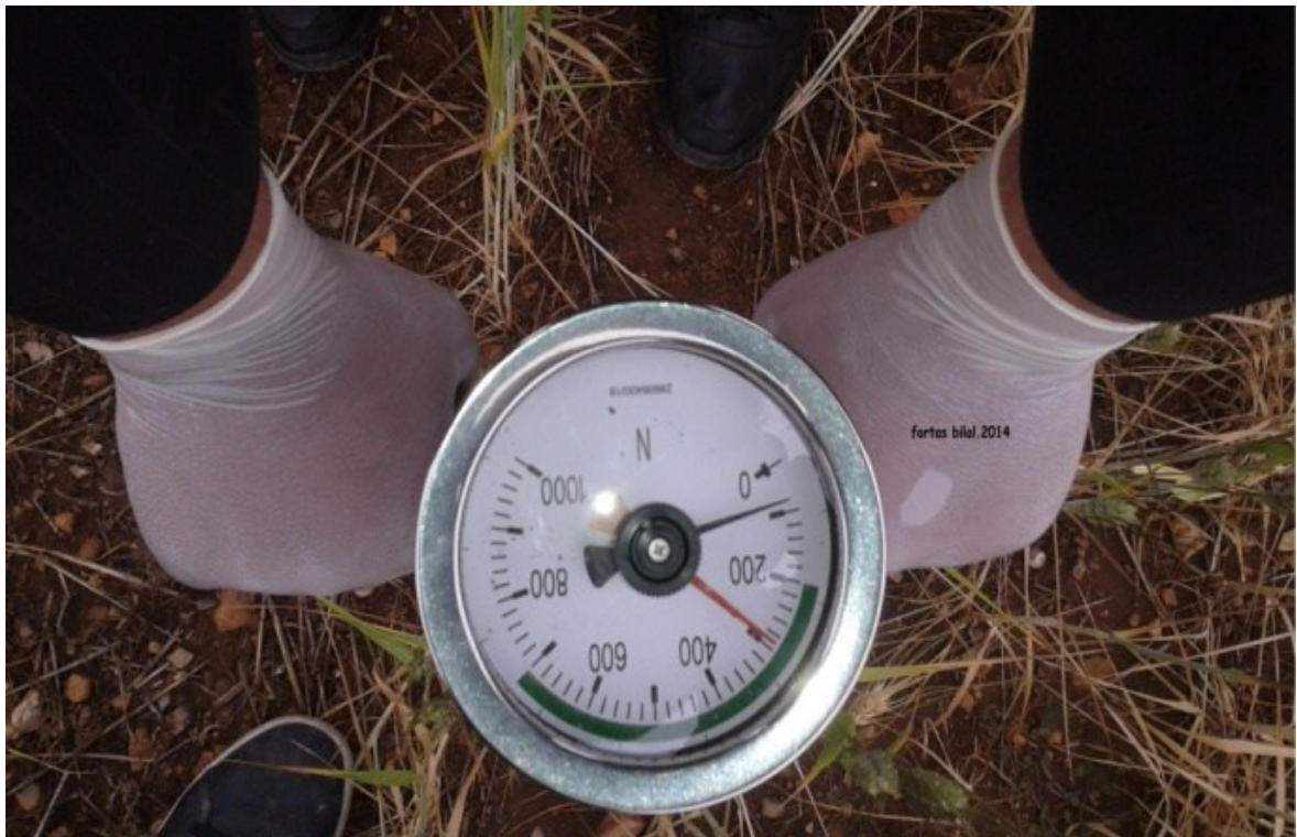
Figure 2.5 : mesure de la résistance pénétrométrique du sol (FORTAS ,2015).
