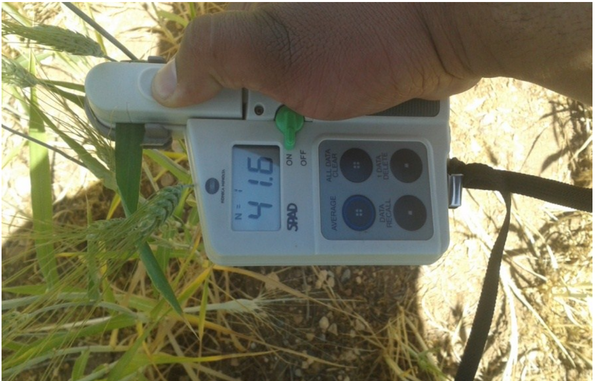
Figure 2.7. Mesure de la teneur en chlorophylle sur des feuilles de blé dur, faite sur le d'expérimentation (FORTAS, 2015).
