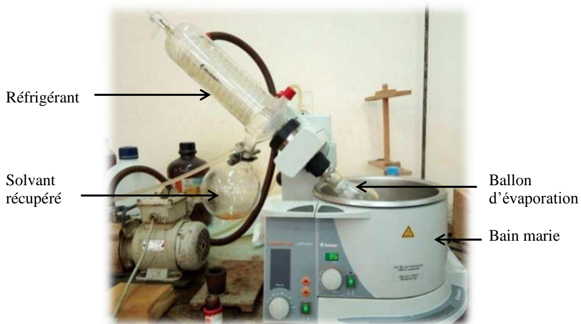
Figure 2.3 : Evaporation à sec avec le rota-vapeur.
