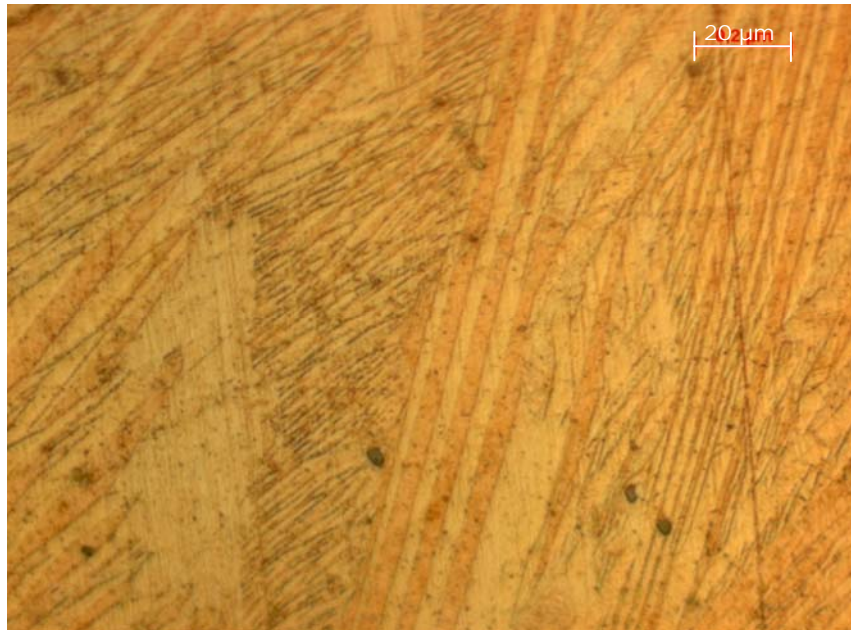
Fig. 4.19. Micrographie optique de la structure de l'échantillon à l'état de trempe à l'eau depuis l'état monophasé \beta .
