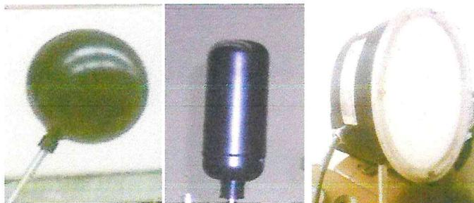
Figure 12 : Chambres d'ionisation utilisées en radioprotection.
