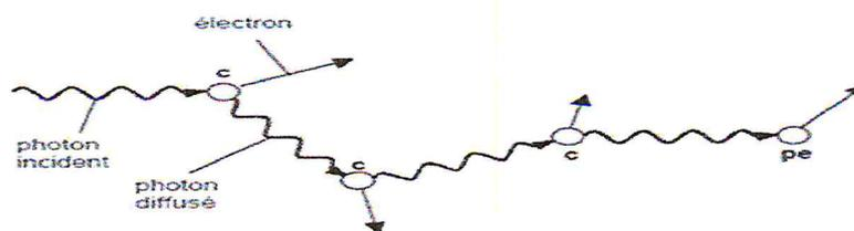
Figure 1.12. Suite d'interaction Compton (c) finissant par une interaction photoélectrique (pe).
