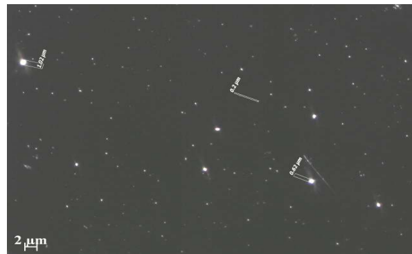
Figure V.2 : dépôt Al-Si-Cu-Mg 13% sur substrat en silicium.
