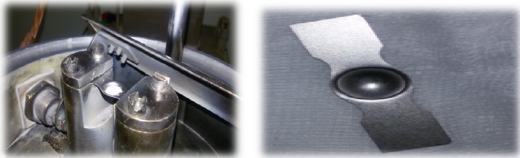
Figure IV-3 : Creuset en tungstène.
