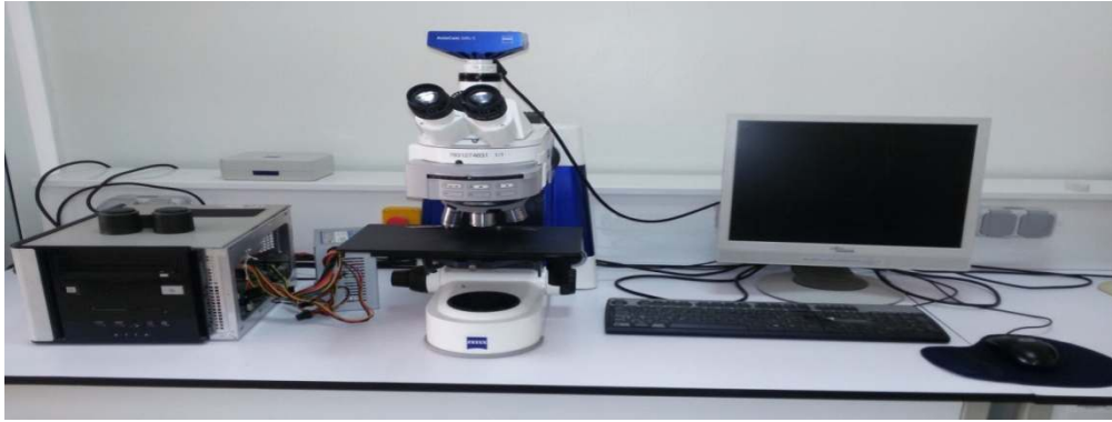
Figure IV-11 : Microscope optique métallographie ZEISS AXIO IMARER A2.
