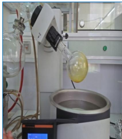
**Figure II.5 :** Evaporation des solvants.
