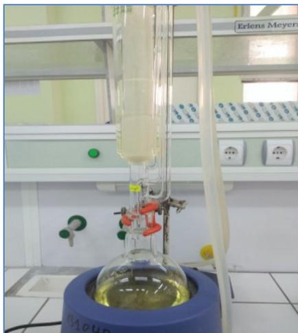
**Figure II.4 :** Extraction par soxhlet.
