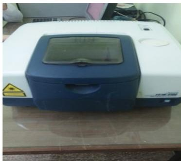
**ANNEX 04** : spectrophotomètre IR Jasco FT/IR-400.
