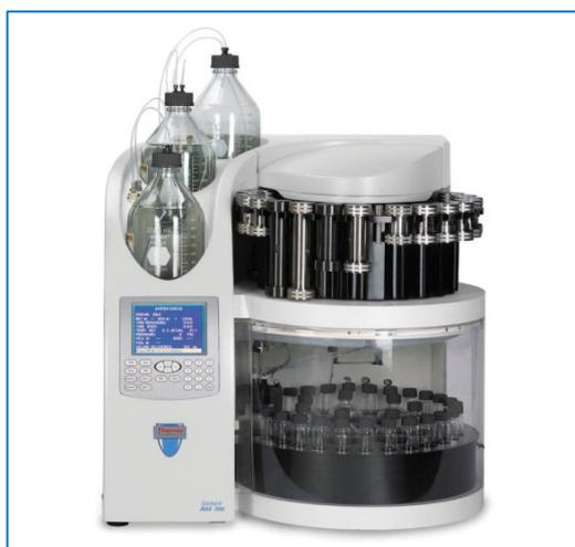
**Figure I.19 :** l'appareillage Extraction accélérée par solvant.
