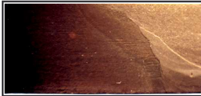
Figure 4.2 : macrographie de la soudure avec une 1 ère réparation (R1)
