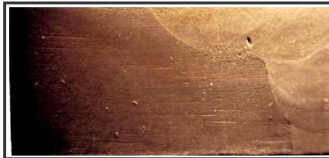
Figure 4.3 : macrographie de la soudure avec une 2 ème réparation (R2)
