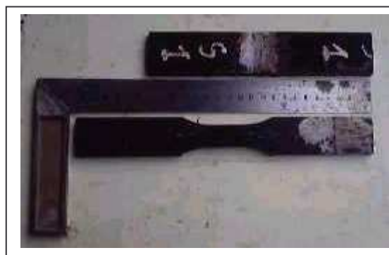
Figure 3.11 : Dimension réel de l'éprouvette de traction et de pliage
