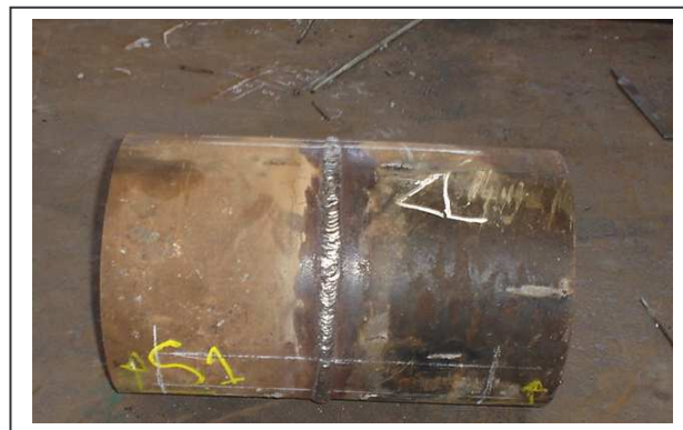
Figure 3. 8 : tube soudé avant prélèvement d'éprouvettes
