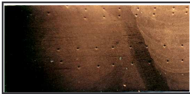
Figure 4.1 : macrographie de la soudure initiale (non réparée) (S1)
