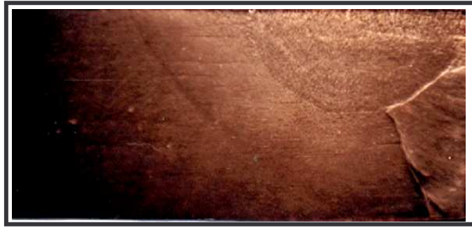
Figure 4.4 : macrographie de la soudure avec une 3 ème réparation (R3)
