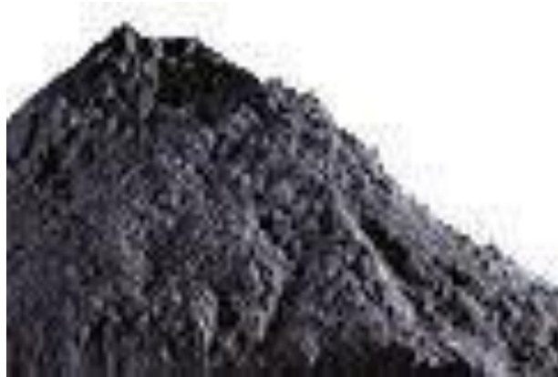
Figure 3.2: Charbon actif en poudre(CAP).
