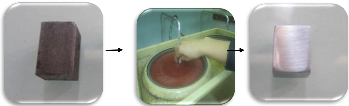
Figure 2.4 : Echantillon avant et après polissage.
