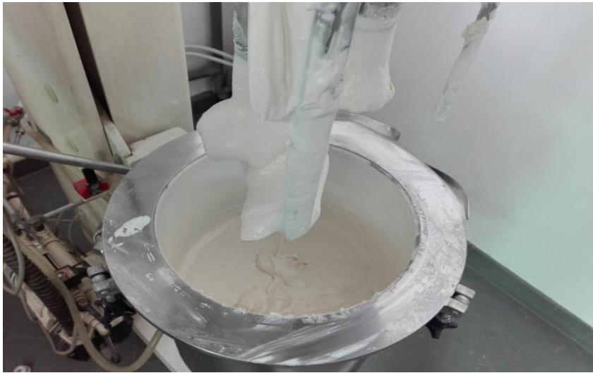
Figure 3.6 : Fabrication de la pâte dentaire à l'échelle pilote
