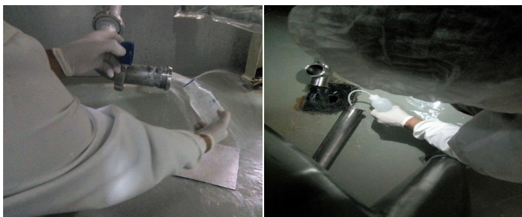
Figure 3.14 : prélèvement microbiologique d'eau de rinçage
