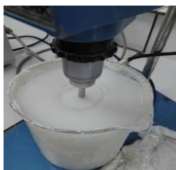
Figure 3.4 : Nettoyage en agitant à l'aide d'agitateur à palette
