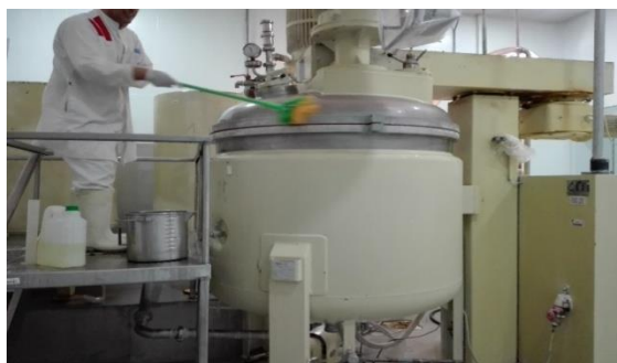
Figure 3.11 : Désinfection de l'extérieure de la cuve de mélange
