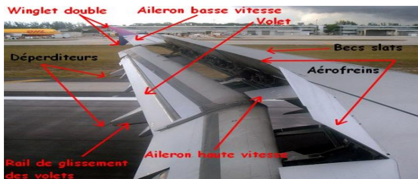
Figure (1.7) : Constituants de l'aile
