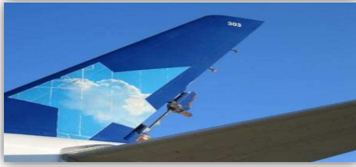
Figure (I.6 Arrachement de la gouverne de direction d'un Airbus A310-300 suite à du flottement
