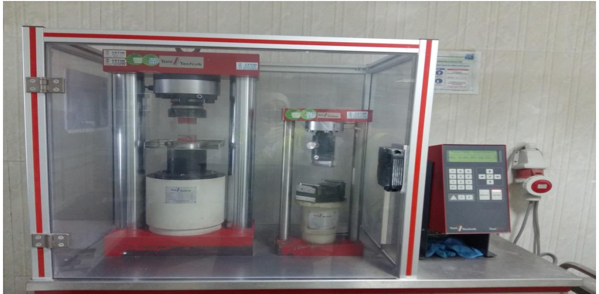
Figure 2.11 : presse pour les essais de flexion et de compression sur éprouvettes 4×4×16 cm.
