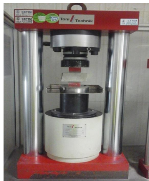
Figure 2.11.2 : presse pour compression.
