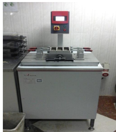
Figure 2.10 : table à vibration.
