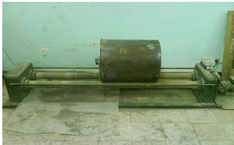
**Figure 3-3** : Broyeur à boules pour poudre.
