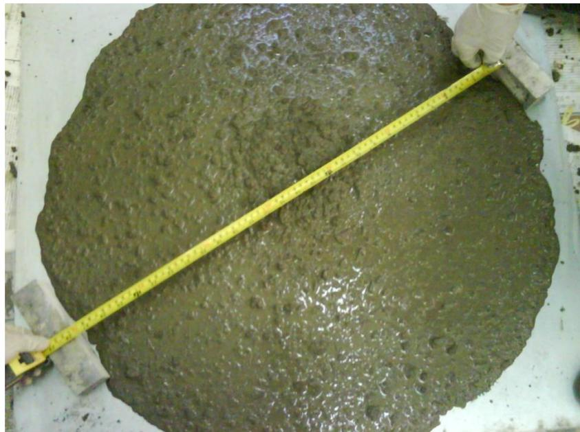
**Figure 3-23:** Mesure de diamètre à l'essai au cône d'Abrams.
