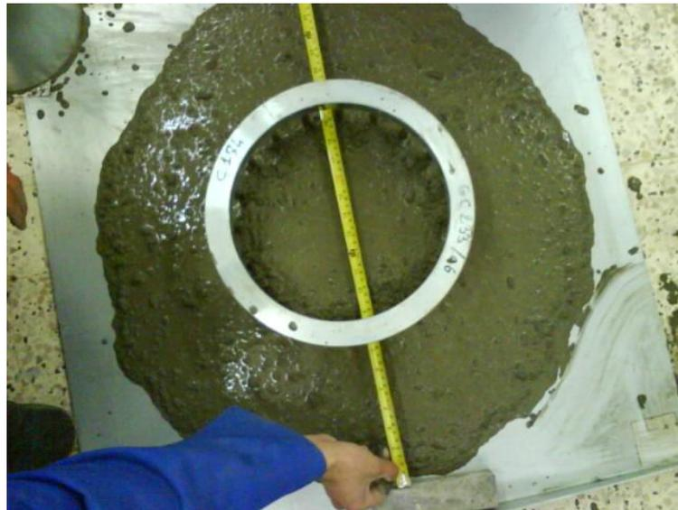
**Figure 3-28** : Mesure du diamètre à l'essai à la couronne J (J-Ring test).
