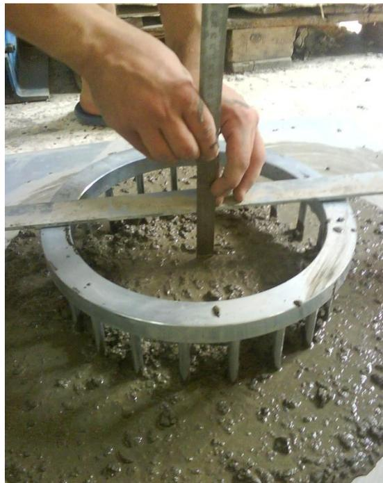
**Figure 3-29** : Mesure la différence de hauteurs  $B_j$  J (J-Ring test).
