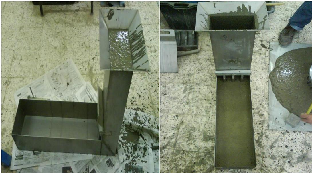
**Figure 3-26** : Essai à la boîte en L (L-Box test).
