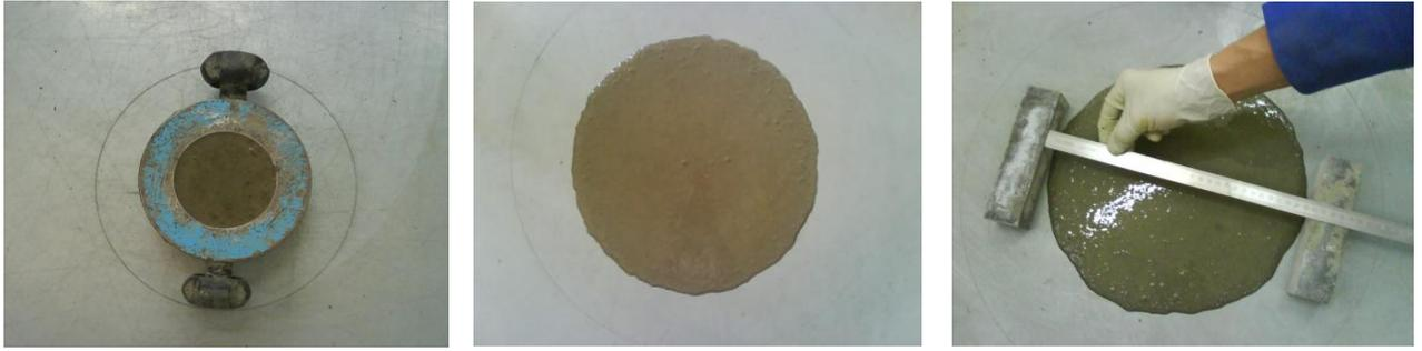
**Figure 3-19** : Mesure de diamètre de la galette de mortier.
