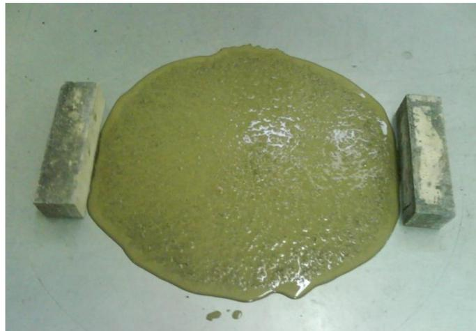
**Figure 4-2 :** Etalement du mortier recyclé à un dosage de 2,20% de Sp.
