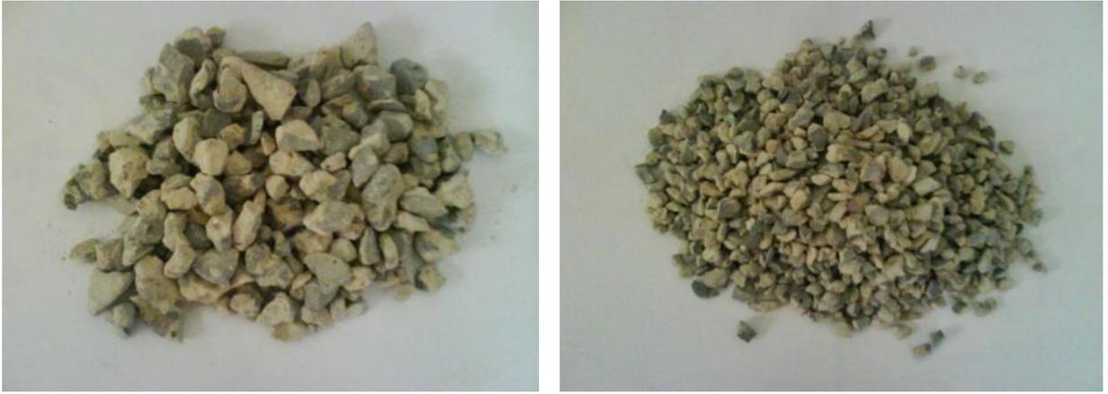
**Figure 3-9 :** Gravier 8/15 et 3/8 recyclés.
