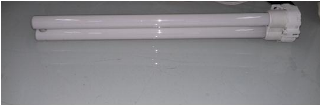
Figure 3.4 : Photo numérique montrant la lampe ultra-violette PL-L 24W/10/4Pole.
