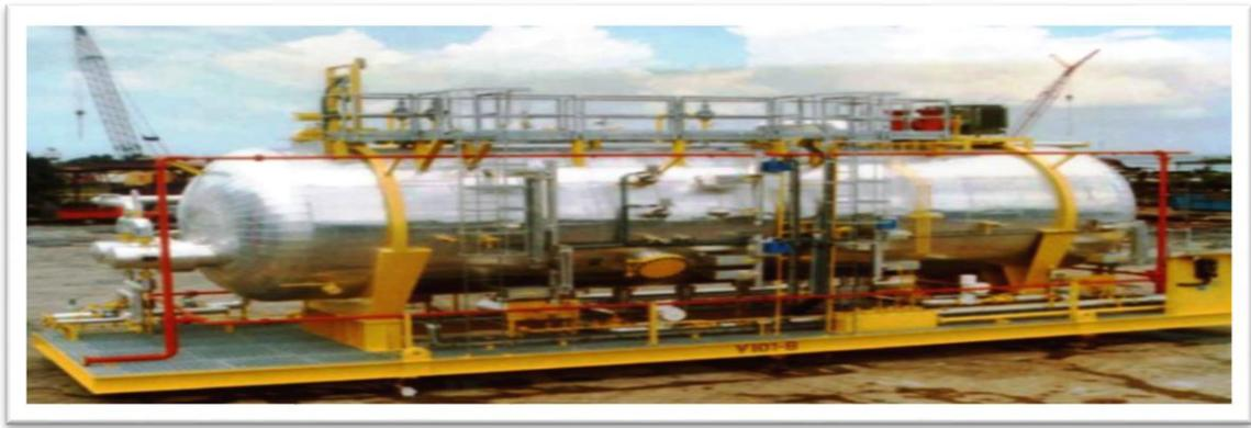
Figure III -13: Vue extérieure d'un dessaleur électrostatique
