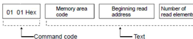
Figure 17 : Exemple de commande FINS
