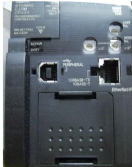
Figure 10 : Les ports de CJ2M
