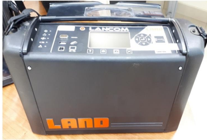
Figure II.8 : Appareil d'analyse des gaz de combustion
