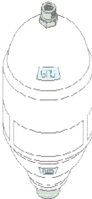
Figure III.9 : l'accumulateur de puissance
