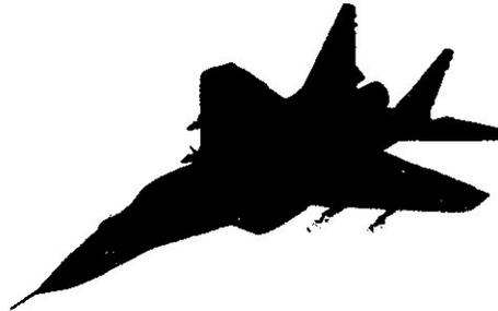
Figure 1-12 : voilure en flèche (MIG 29 SMT)
