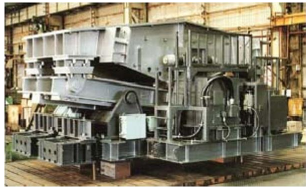
(b) amortisseur hybride de masse (HMD)
