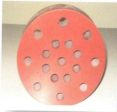
Figure III.7 : Fantôme CT-Cal avec les différents matériaux (inserts)
