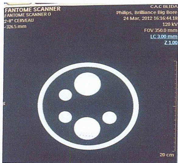
Figure III.14 : Image tomodensitométrique du fantôme Philips CT
