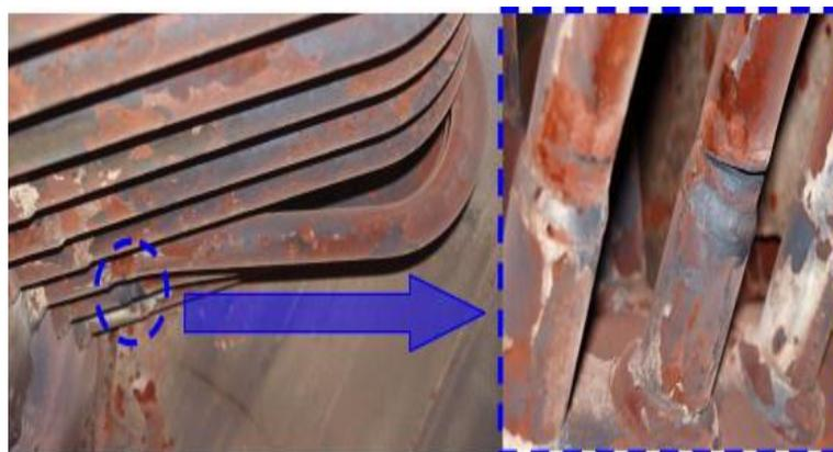
**Figure 1.9** : Condition de tubes échoués déformé et fissuré [10]
