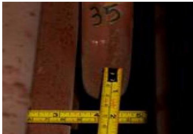
Figure 1.11 : Mesure du déplacement du tube montre 45 mm de la position d'origine [10]
