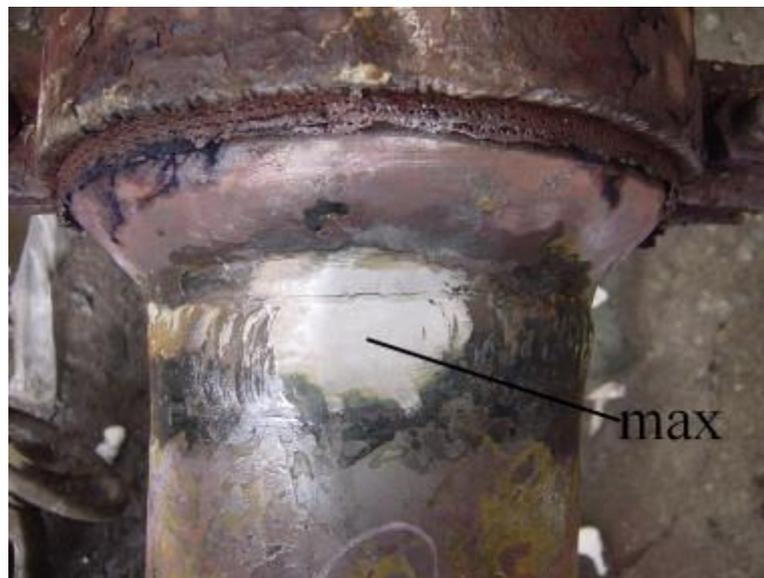
**Figure 1.20** : Fissuration d'un tube conique entretien pour 100.000 h [14]
