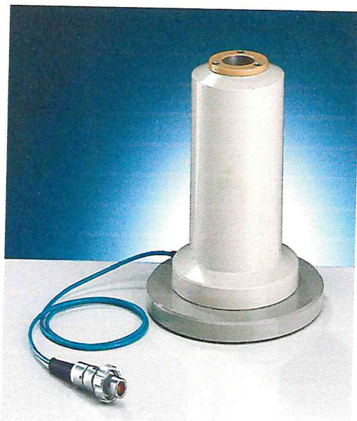
La chambre d'ionisation HDR-1000 d'imagerie standard (Standard Imaging Inc, Middleton, Wisconsin, Etats-Unis) Ceci est la version commerciale disponible d'une chambre à l'origine conçue par Attix. 65 le modèle actuelle HDR-1000 avec plusieurs inserts ou des adaptateurs pour les différentes sources ou radionucléides.
