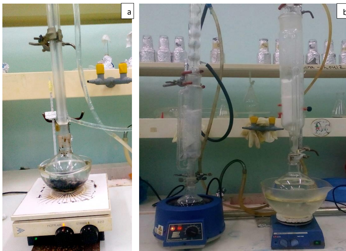
Figure a.1 : montage à reflux d'activation chimique (a) et de lavage (b)
