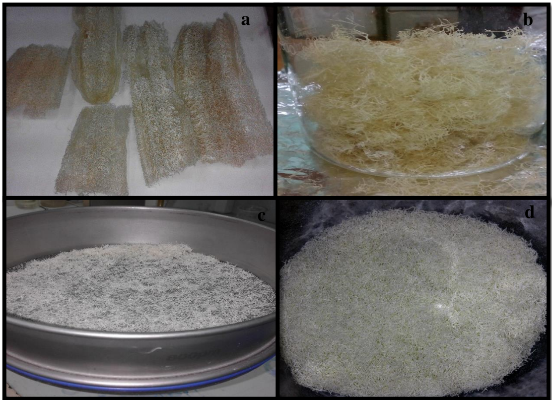
Figure 4.1 : Prétraitement de la matière première (a) : La luffa après séchage, (b) : La luffa découpé, (c) : Le tamisage de la luffa, (d) : La luffa retenue ( \phi=800\mu\text{m} ).
