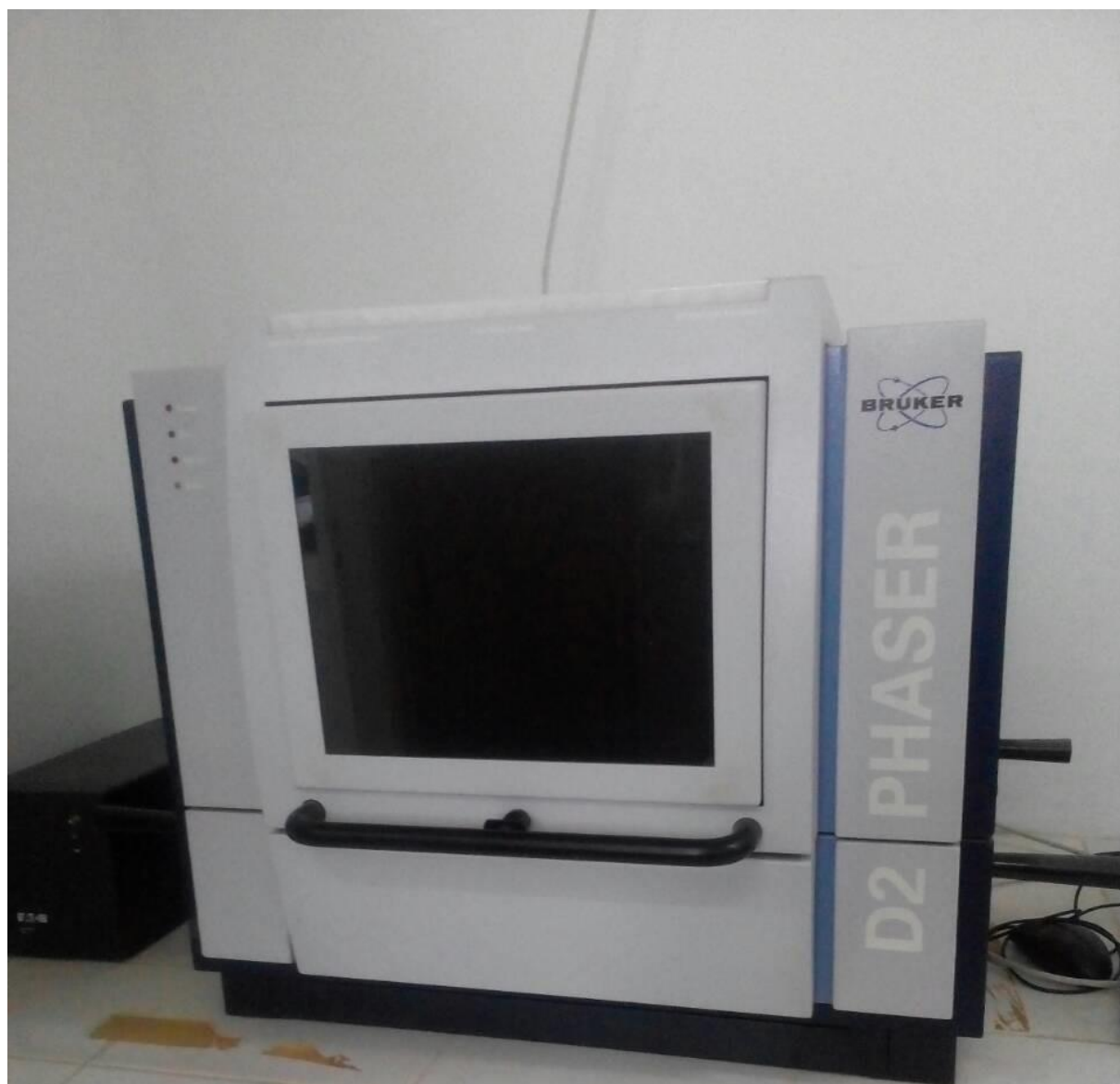
Figure a.7: Diffractomètre d'analyse de diffraction de rayon X (DRX)
