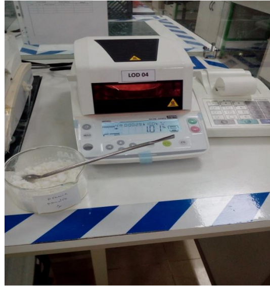
Figure 4.1 : photo représentant l'appareil de LOD.
