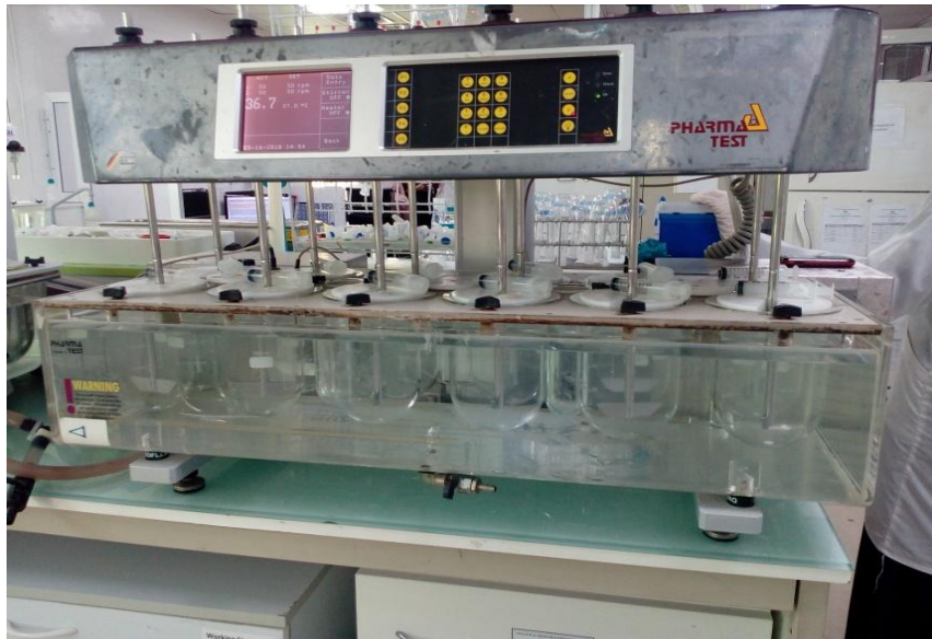
Figure 4.8 : photo représentant appareil du test de dissolution.
