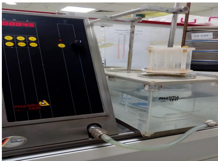
Figure 5.8 : photo représentant appareil du test de désagrégation.
