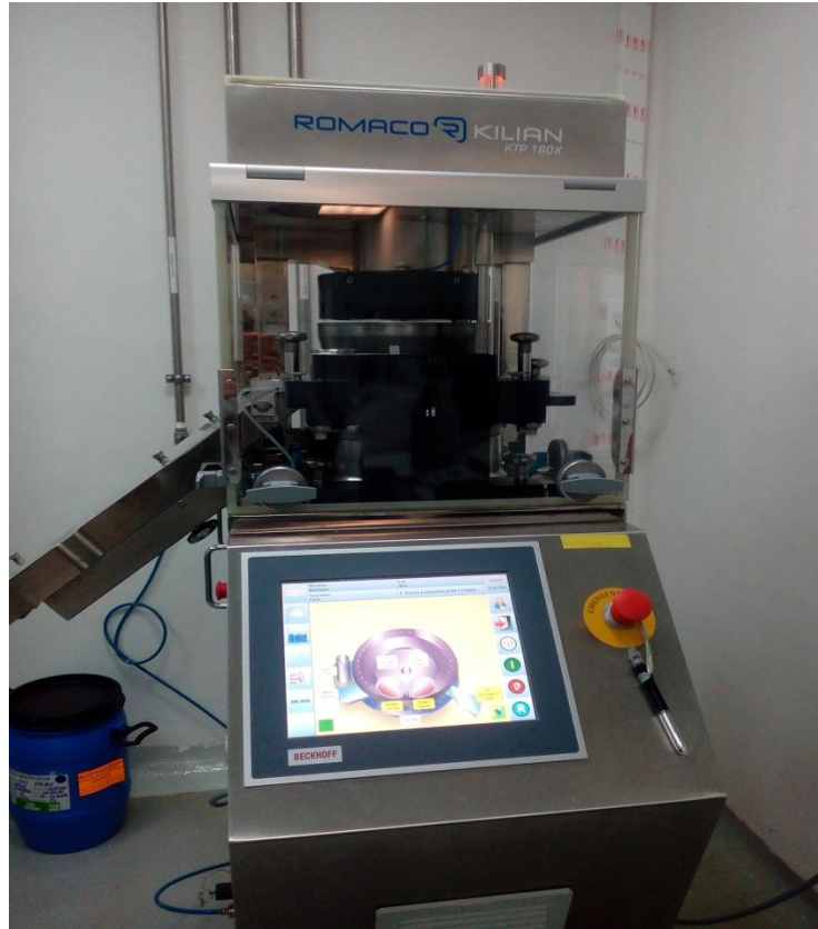
Figure 4.5 : vue réelle d'une presse à compriimer rotative.
