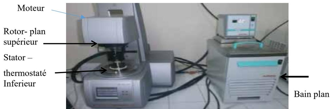
**Figure 3.6 :** Rhéomètre Anton Paar Modular Compact Rheometer MCR 302.
