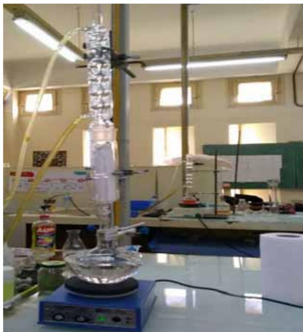
**Figure 3.1 :** Extraction par soxhlet.
