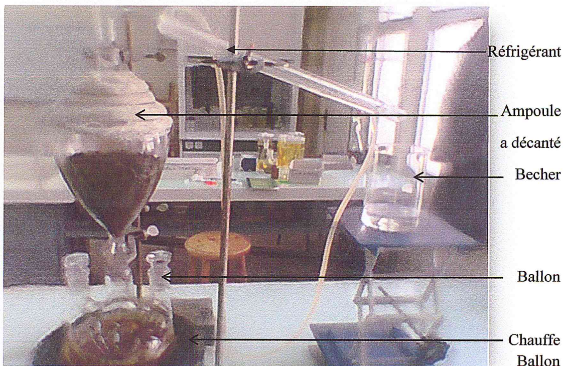
Figure 12: Montage d'entraînement à la vapeur d'eau.
